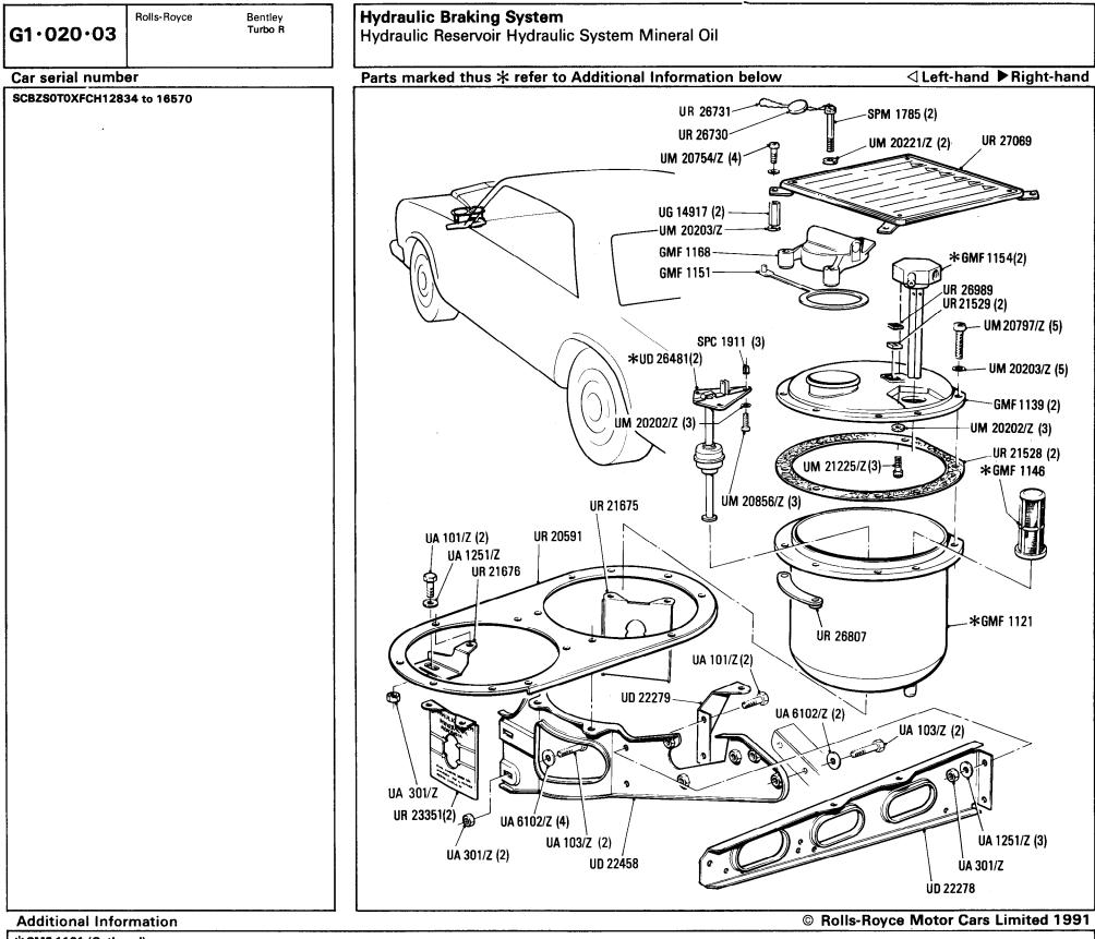
\*GMF 1121 (Outboard) GMF 1137 (Inboard) \*GMF 1154 (Outboard) GMF 1152 (Inboard) \*GMF 1146 (Outboard) \*GMF 1140 (Inboard) GMF 1142 Lock Ring GMF 1143 Stud \*UD 26481 (Outboard) GMF 1145 (Inboard)
