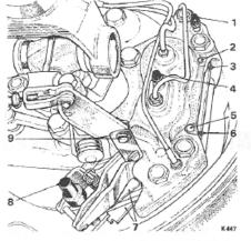
FIG. G44 REAR BRAKE CALIPERS (EARLY CARS)
